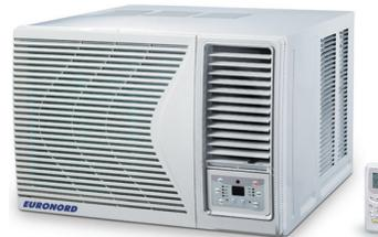
В настоящее время оконный кондиционер — это самая простая климатическая установка. Все элементы оконного кондиционера — компрессор, теплообменники испарителя и конденсатора, электродвигатели и вентилятор, а также панель управления размещены в одном корпусе, образуя моноблок.
